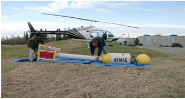
Рис 1: Подвесная AFMAG прототип система, 2001, (Kuzmin et al., 2005)
