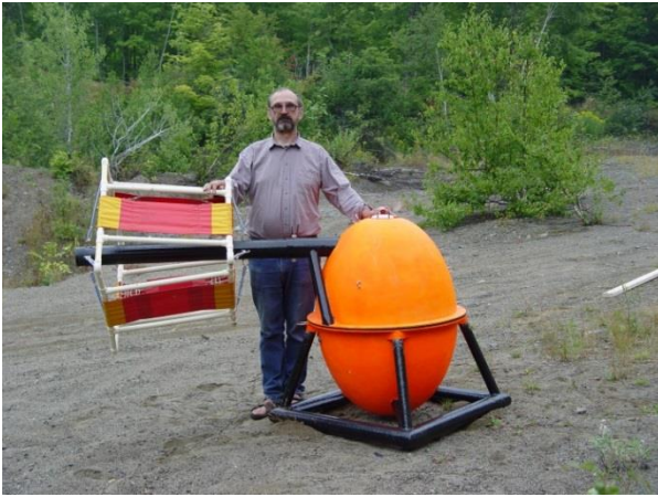
Рис 2: Geotech аэро AFMAG система в Садбери, Ontario с главным разработчиком, Dr. Петром Кузьминым. (Lo and Kuzmin, 2004).
