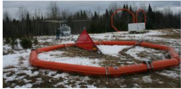
Рис 3: ZTEM z-осевой ресивер и катушки базовой станции на полевых испытаниях в Сев. Онтарио, Canada в 2006 году (Lo and Kuzmin, 2008).
