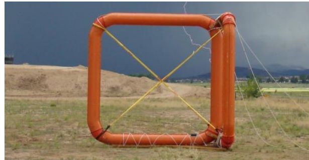
Рис 4: ZTEM измерительная базовая станция в 2007 году при съемочных работах в Аризоне, США (Lo and Kuzmin, 2008).
