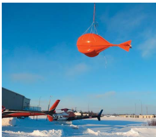
Рис. 1. MobileMT базовая станция регистрации электрического поля (слева), подвесная измерительная система магнитного поля (справа)
